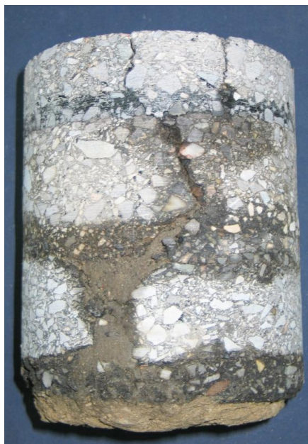
Rysunek 5.17 Echogram w pobliżu wiercenia W1_C_S i wygląd bocznej powierzchni rdzenia z powiększeniem poszerzonej i wypełnionej materiałem ilastym szczeliny w dolnych warstwach asfaltowych.
