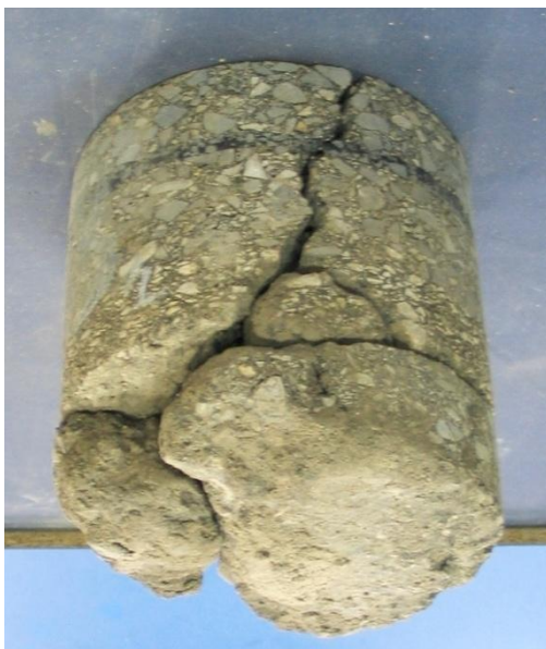
Rysunek 5.18 Echogram w pobliżu wiercenia W2_C_S i wygląd zrekonstruowanego z fragmentów rdzenia oraz fotografia wnętrza otworu.
