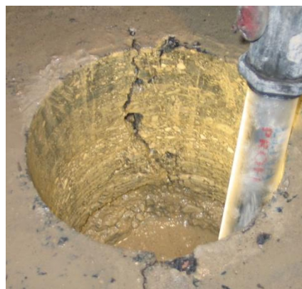
Rysunek 5.20 Echogramy wykonane w pobliżu wiercenia W4_C_S i wygląd zrekonstruowanego z fragmentów rdzenia oraz fotografia wnętrza otworu.
