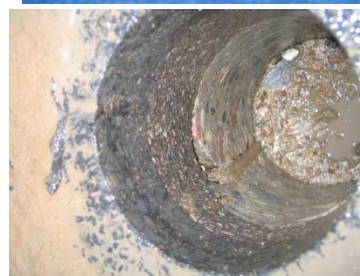
Rysunek 2.4 Poskładane (do konfiguracji pierwotnej) fragmenty rdzenia W1_A1_S (widoczny fragment deski szalunkowej, fragment łącznikowej rury zbrojeniowej, skorodowane fragmenty cienkich prętów zbrojeniowych jeden pod rurą, a drugi w spągu betonu, rozwierająca się ku dołowi szczelina w dolnych warstwach asfaltowych, rozległe zniszczenia ze zmianami mineralnymi na połączeniu warstw asfaltowych z warstwą betonową, a zachodzące głównie w stropie betonu), zbliżenie fragmentu górnego (z widoczną szczeliną biegnącą w dół od wypełnionego spoiwem nacięcia w warstwie ścieralnej) i widok na otwór tuż po odwierceni (widoczny fragment deski szalunkowej w betonowym segmencie ściany otworu).
