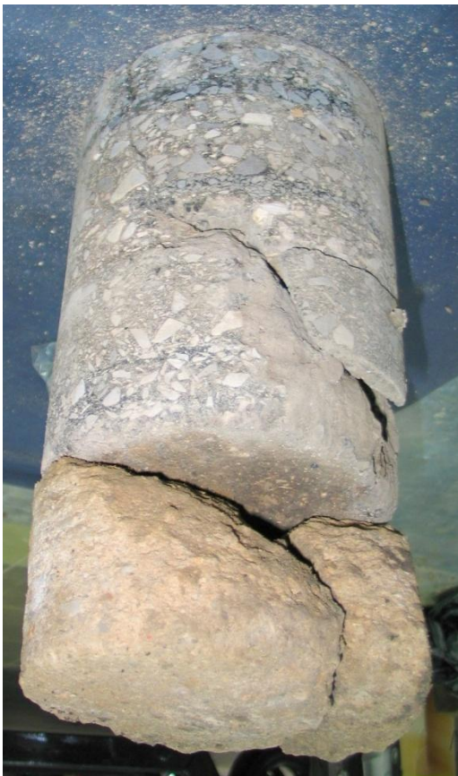
Rysunek 5.19 Echogramy wykonane w pobliżu wiercenia W3_C_S i wygląd poskładanego z fragmentów rdzenia (warstwy asfaltowe i fragment podbudowy), powiększenie powierzchni szerokiej szczeliny głównej pęknięcia w dolnych warstwach asfaltowych (pod małym fragmentem rdzenia) wypełnionej materiałem ilastym oraz fotografia wnętrza otworu.
