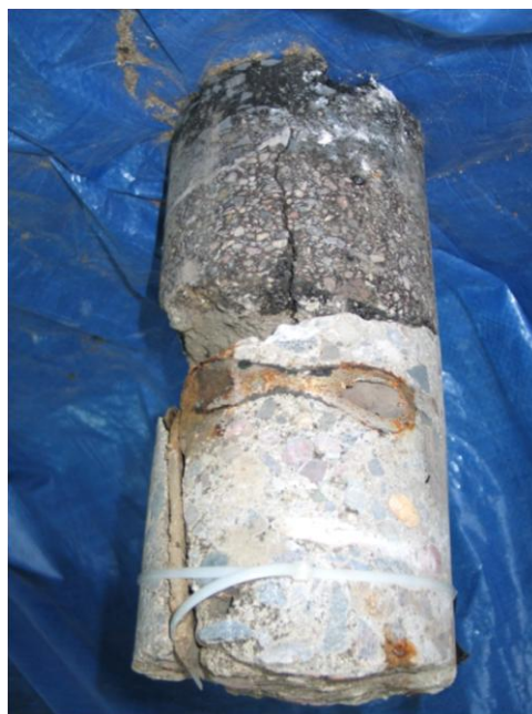
Rysunek 2.4 Poskładane (do konfiguracji pierwotnej) fragmenty rdzenia W1_A1_S (widoczny fragment deski szalunkowej, fragment łącznikowej rury zbrojeniowej, skorodowane fragmenty cienkich prętów zbrojeniowych jeden pod rurą, a drugi w spągu betonu, rozwierająca się ku dołowi szczelina w dolnych warstwach asfaltowych, rozległe zniszczenia ze zmianami mineralnymi na połączeniu warstw asfaltowych z warstwą betonową, a zachodzące głównie w stropie betonu), zbliżenie fragmentu górnego (z widoczną szczeliną biegnącą w dół od wypełnionego spoiwem nacięcia w warstwie ścieralnej) i widok na otwór tuż po odwierceni (widoczny fragment deski szalunkowej w betonowym segmencie ściany otworu).
