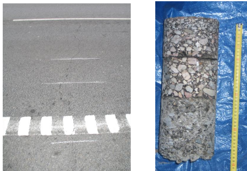
Rysunek 2.17 Miejsce wykonania wiercenia W1_B_S (po lewej, trzy kreski oznaczają kierunki i pozycje trzech równoległych profili, a na środkowej w miejscu jej przecięcia z pęknięciem zostało wykonane wiercenie) oraz uzyskany rdzeń (po prawej)
