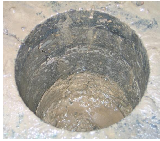
Rysunek 5.19 Echogramy wykonane w pobliżu wiercenia W3_C_S i wygląd poskładanego z fragmentów rdzenia (warstwy asfaltowe i fragment podbudowy), powiększenie powierzchni szerokiej szczeliny głównej pęknięcia w dolnych warstwach asfaltowych (pod małym fragmentem rdzenia) wypełnionej materiałem ilastym oraz fotografia wnętrza otworu.
