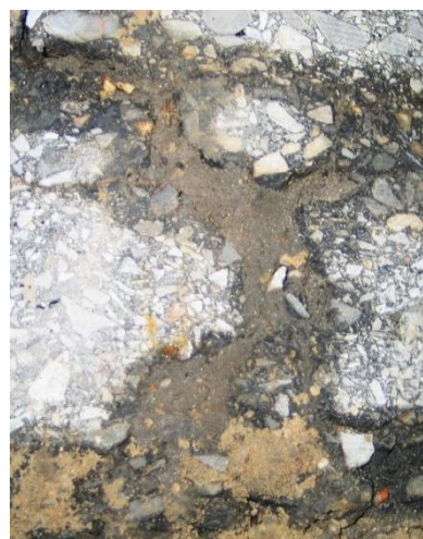
Rysunek 5.17 Echogram w pobliżu wiercenia W1_C_S i wygląd bocznej powierzchni rdzenia z powiększeniem poszerzonej i wypełnionej materiałem ilastym szczeliny w dolnych warstwach asfaltowych.
